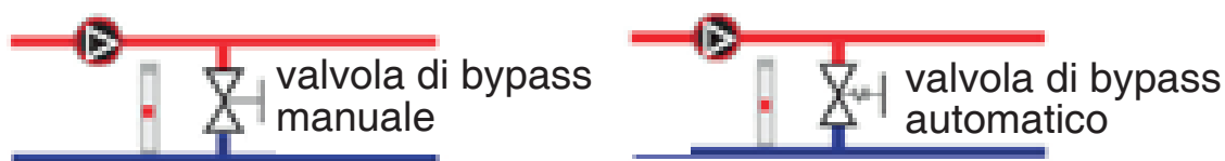
Figura 10 - Sistema installato con valvola by-pass
